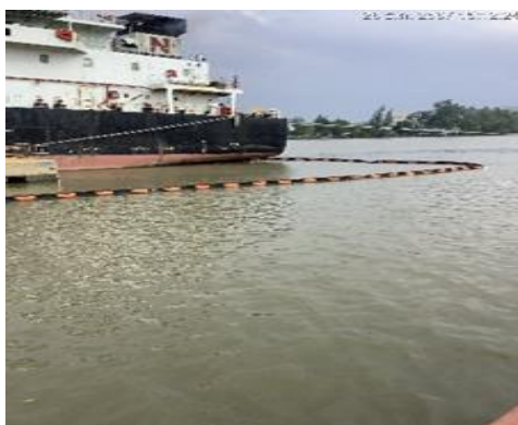
ภาพที่ 6 การล้อมพุน (Boom) รอบลำเรือบรรทุก
